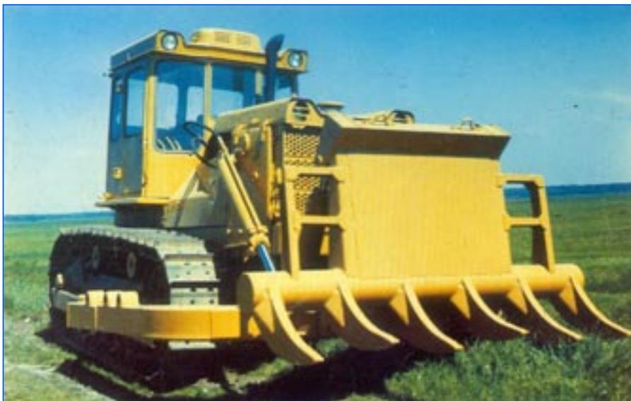
Предназначен для срезки, сгребания и сплошной корчевки кустарника и мелкокося диаметром до 120 мм, штучной корчевки пней диаметром до 650 мм и камней массой до 3 т. - на осушенных и не требующих осушения землях.
